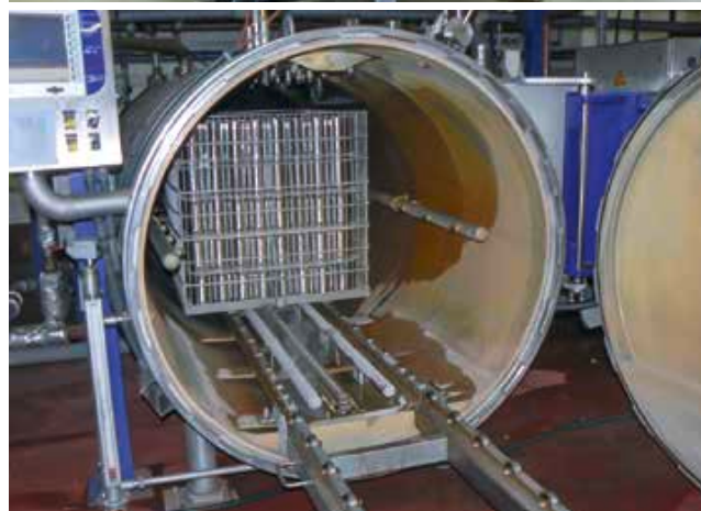
In Körben, die etwa eine Tonne Dosenmasse aufnehmen können, kommt das Fleisch zur Sterilisation in den Autoklaven. / The meat is sterilised in autoclaves in baskets that can hold about one tonne of can mass.
