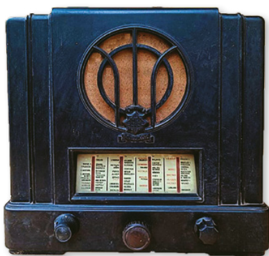
Empfängt Mittel- und Langwellensender: Das 1932 von der Firma Radiotechna in Píleuó bei Pardubice als Telefunken-Lizenz hergestellte Radio T300
